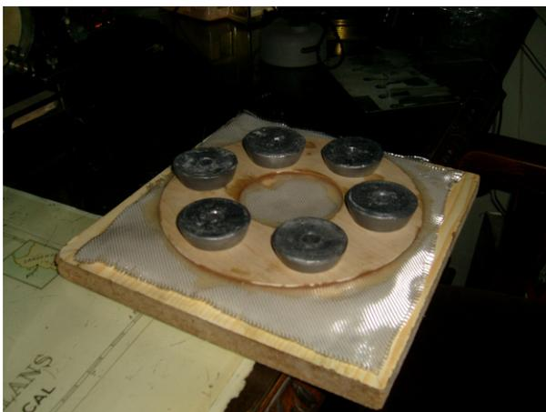
En esta foto se ve el sanwix de los discos , formado por dos discos de madera, abedul/abedul o abedul haya, pegados entre si mediante capa intermedia de f.v. y epoxy.
