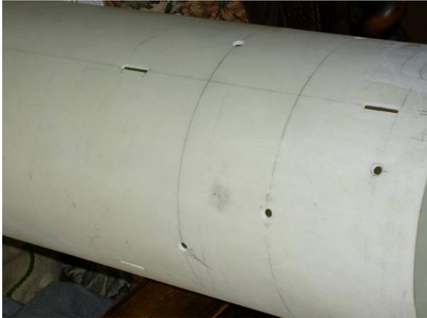
Respecto a las aletas del 2º tramo, van pegadas en superficie con unos tetones que atraviesan la pared del tubo principal.
