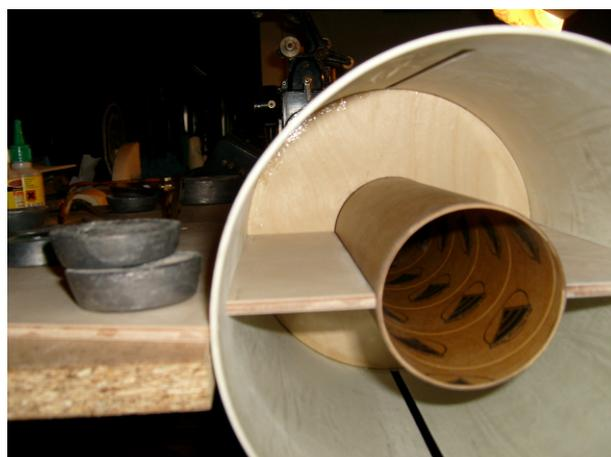
Colocación de las aletas con el tubo portamotor, de dos en dos opuestas.
