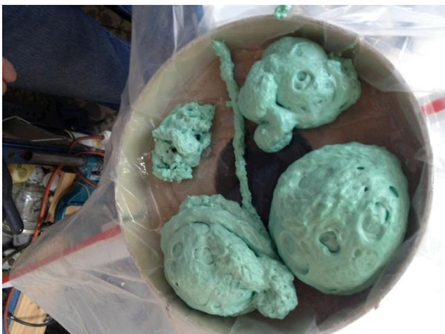
Salida del sobrante de la espuma de PU al expandirse.
