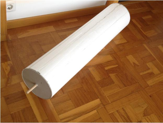
Se construye a partir de planchas de porexpan de 22 gr/l. De 50mm de grosor que se pegan insertando un listón redondo de madera.
