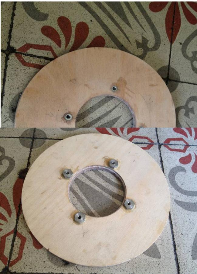
Tuercas especiales para sujetar el motor, fabricadas torneando un tornillo y roscando a M5.
