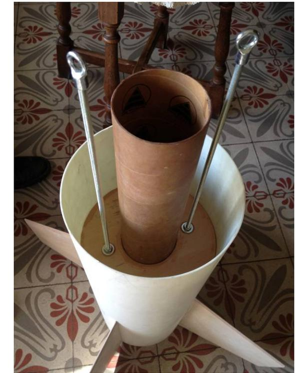
A partir de disco nº 4 (comenzando a contar desde la tobera) en la imagen se inserta varilla roscada de M6 con tuerca y arandela en ambas caras del disco, pegadas con Araldit, el proceso se repite en el disco nº5 culminando en cáncamo hembra para sujetar el sistema de recuperación.
