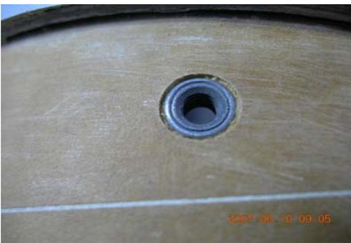
**Fig. 25 Tuerca remachada y encolada con epoxi.**
