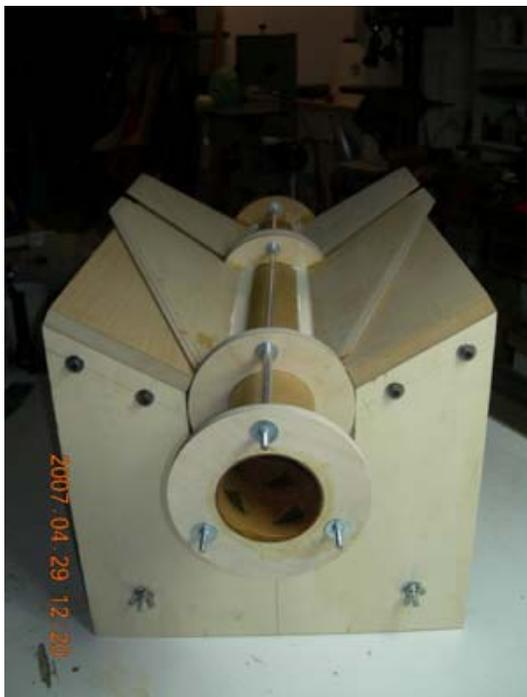
Fig. 9 Se han aplicado juntas de epoxi a las aletas antes del laminado, pueden verse las barras roscadas de reparto de cargas.
