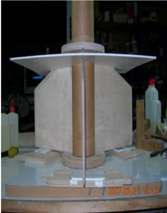
Fig. 7 Alineado de las aletas inferiores y encolado con epoxi.
