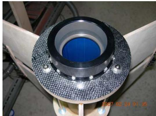
**Fig. 13** Retenedor de motor Aeropak de 75 mm.
