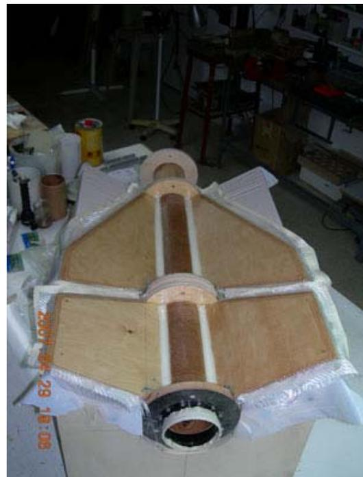
Fig. 10 Laminado de punta a punta de las aletas con fibra de vidrio de 6 oz. Y epoxi.
