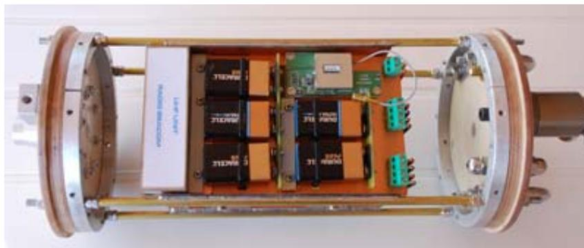
**Fig. 27 Etapa de potencia en el interior de la bodega, en el lado izquierdo de la imagen puede verse el soporte del boton del rail.**
