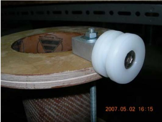
**Fig. 12** Botón superior de rail fabricado en Delrin.
