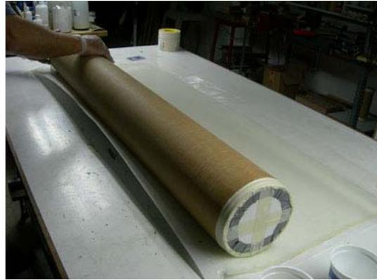
Fig. 16 Se enrolla el tubo con la fibra de vidrio impregnada de epoxi.
