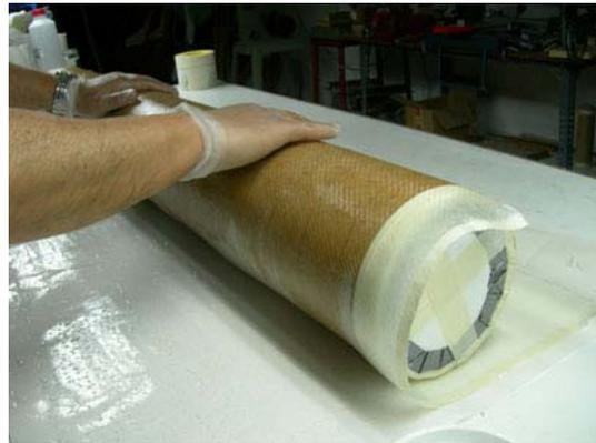
Fig. 18 Segundo laminado de fibra.
