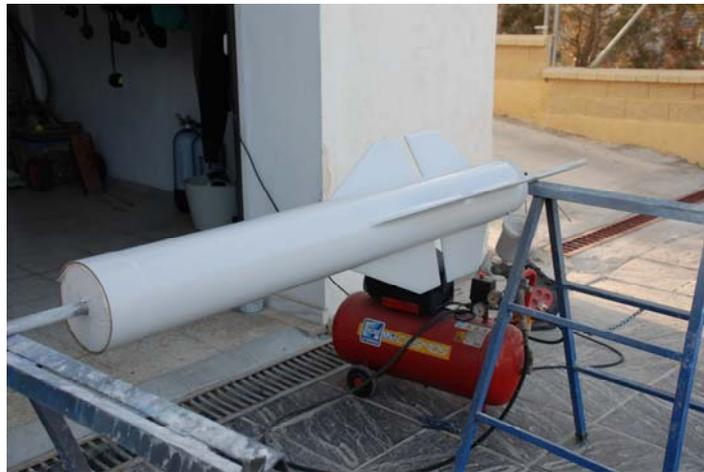
Fig. 54 Pintura de acabado de poliuretano de dos componentes Ral 9010.
