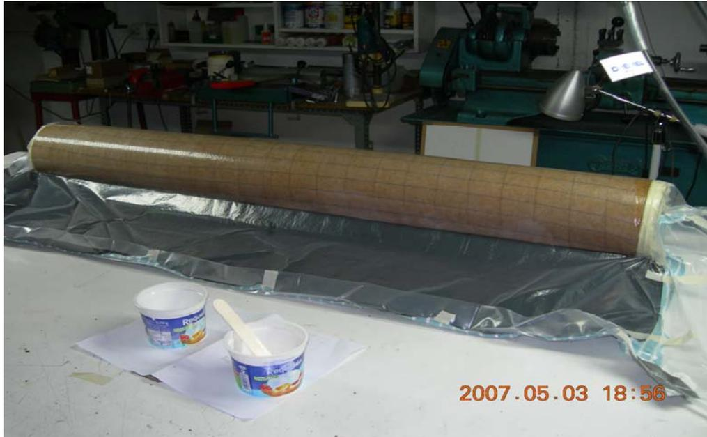
Fig. 20 Luego se introduce en una bolsa de vacío.
