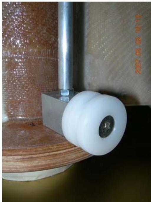
**Fig. 14.** Botón de rail inferior fabricado en Delrin.
