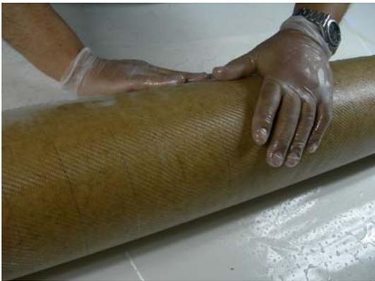
Fig. 17 Ajuste de la fibra de vidrio.
