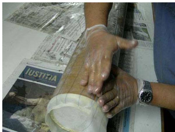
Fig. 19 El último laminado se cubre de una capa del pil-ply desechable para un mejor acabado final.
