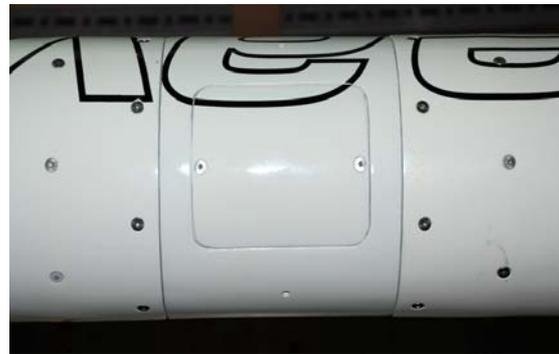
**Fig. 26 Las dos secciones del fuselaje se unen a la bodega de electrónica mediante 32 tornillos de acero inoxidable M4 Din 7991.**
