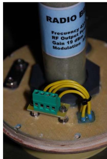
Fig. 49 Bornas de la carga de eyección.
