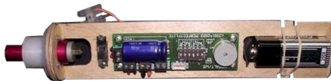
FIGURA 166: Otro tipo de altímetro montado en su soporte.
