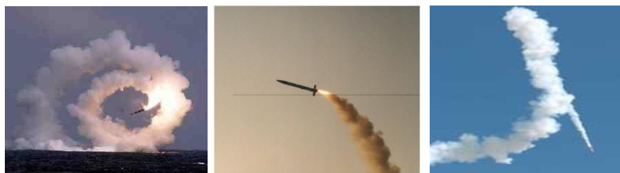
FIGURA 138: Imágenes de algunos cohetes en vuelo inestable. (Foto: VIDROCK)
