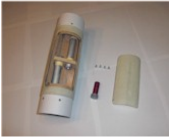
1° sistema doble de eyección.
