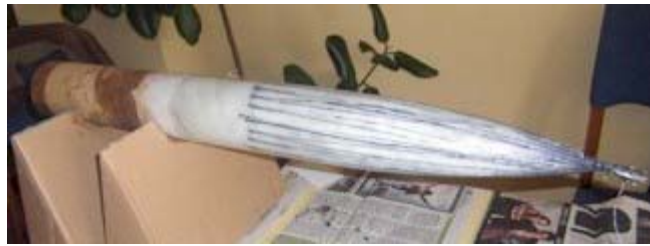
5º construcción de la ojiva con el mismo proceso anterior.
