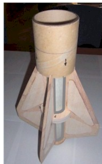
4º encolado y refuerzo con masilla epoxi dos componentes, y enfibrado. 5º acabado ST01 con madera de manzonía e imprimación dos capas, 6º lijado y colocación del retén de motor HARM 38 mm. con epoxi térmico.
