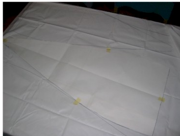
1° corte con patrón sobre Ripstop Nylon naranja y blanco. Se utilizaron dos patrones diferentes, uno para el principal de 1,5 mts. de diámetro y otro patrón para el drogue de 650 mm de diámetro.
