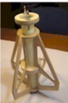
4º encolado y refuerzo con masilla epoxi dos componentes, y enfibrado. 5º acabado ST01 con madera de manzonía e imprimación dos capas, 6º lijado y colocación del retén de motor HARM 38 mm. con epoxi térmico.
