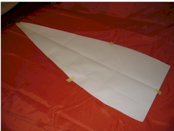
1° corte con patrón sobre Ripstop Nylon naranja y blanco. Se utilizaron dos patrones diferentes, uno para el principal de 1,5 mts. de diámetro y otro patrón para el drogue de 650 mm de diámetro.
