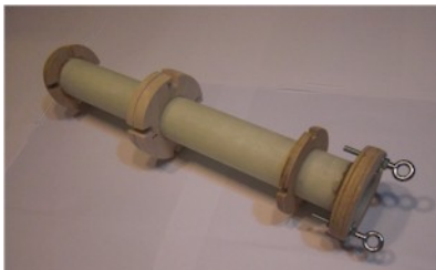
1º montaje de los anillos de centrado.
