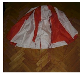
1° corte con patrón sobre Ripstop Nylon naranja y blanco. Se utilizaron dos patrones diferentes, uno para el principal de 1,5 mts. de diámetro y otro patrón para el drogue de 650 mm de diámetro.
