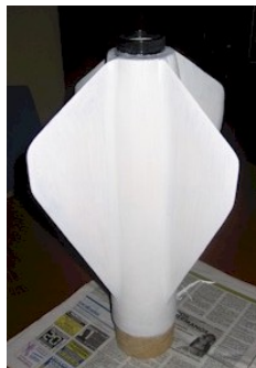
4º encolado y refuerzo con masilla epoxi dos componentes, y enfibrado. 5º acabado ST01 con madera de manzonía e imprimación dos capas, 6º lijado y colocación del retén de motor HARM 38 mm. con epoxi térmico.
